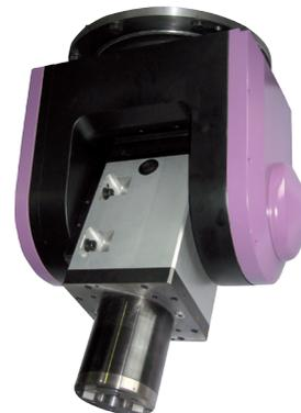
FAST - головка с креплением ISO 40 и энкодером поворота оси
