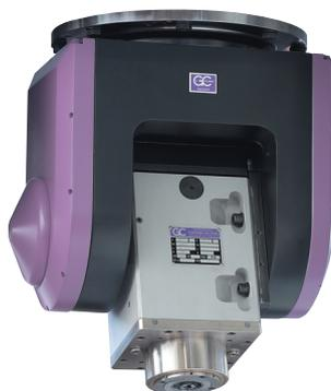
2х осевая головка «вилочного типа», для точной обработки древесины, легких сплавов и композитов (стекловолокно, углепластик). Этот двух осевой узел позволяет выполнять комплексную обработку с повышенной жесткостью за счет двойной опорной конструкцией шпинделя. Передача идет от сервомоторов (оборудованных встроенным энкодером). Шпинделя могут быть заказаны под инструмент HSKF63 DIN 69893 или ISO30.
